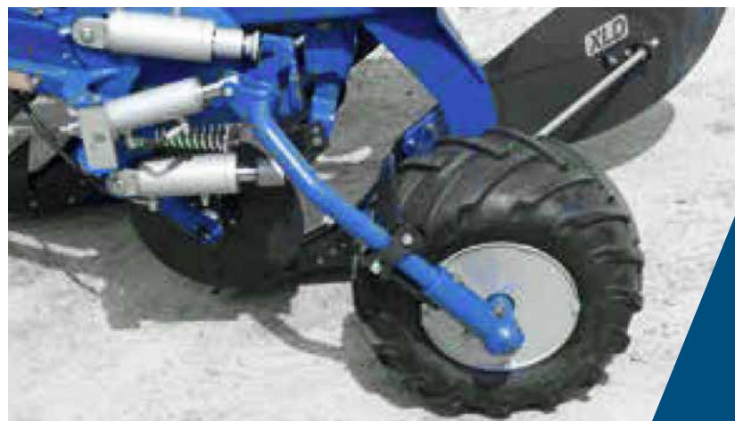
Hydraulisk djupkontroll och följsidor för stöd hjul med traktormönster.
