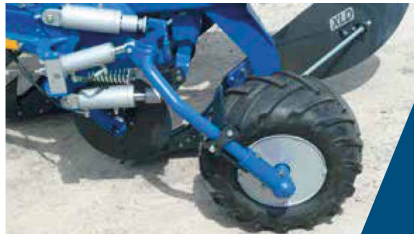
Control hidraulic al adâncimii și protecții laterale pentru roată profil tractor și suport
