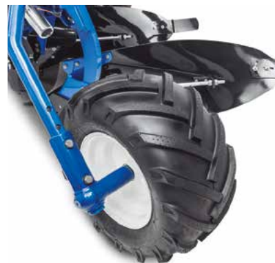
Podpěrné kolo pro traktorový vzor) CX, DX, VFCX, VFCXP Mechanická kontrola hloubky, hydraulické tlumení
