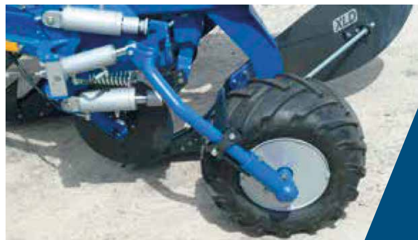
Хидравлично регулиране на дълбочината и странични джанти за опорни колела за тракторен модел.
