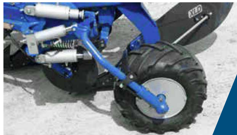
Hydrauliczna kontrola głębokości i kotłaki dla koła podporowego w układzie ciągnikowym.
