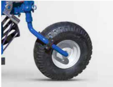
Combi wheel - 10.00/80-12 CX, DX, VFCX, VFCXP
